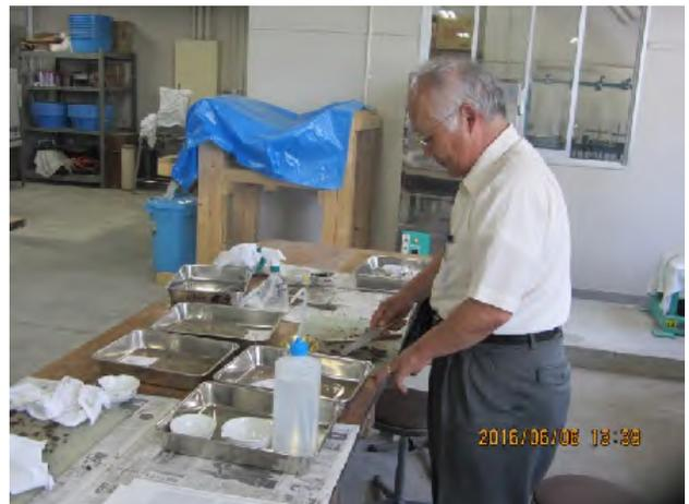
写真-2.5.5(1) 噴砂試料の土質試験実施状況(液性塑性試験)
