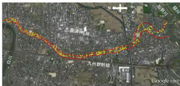
4/22,29,5/1で実施した地盤工学会調査団の現地調査により取得した液状化による噴砂、沈下、変状と思われる地点をプロット。熊本市南区近見から川尻にかけて帯状の液状化現象が生じている。この液状化の帯は幅50mから100m、長さ5km。白川の旧河道であった可能性もある。(白川の旧河道が蓮台寺から川尻に向かって南流し川尻で加勢川・緑川に合流していた可能性を有しているとする大本照憲ら(2010)の研究に一致する。)
