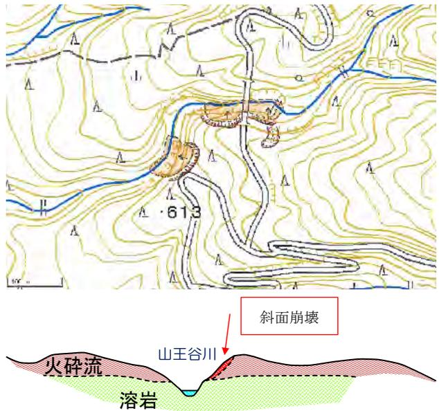
図-2.6.4 遷急線地形の斜面崩壊の分布と模式断面図
