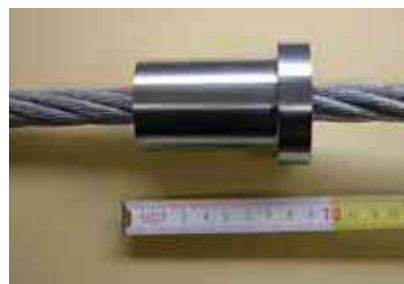
写真 2 エネルギー吸収金具
